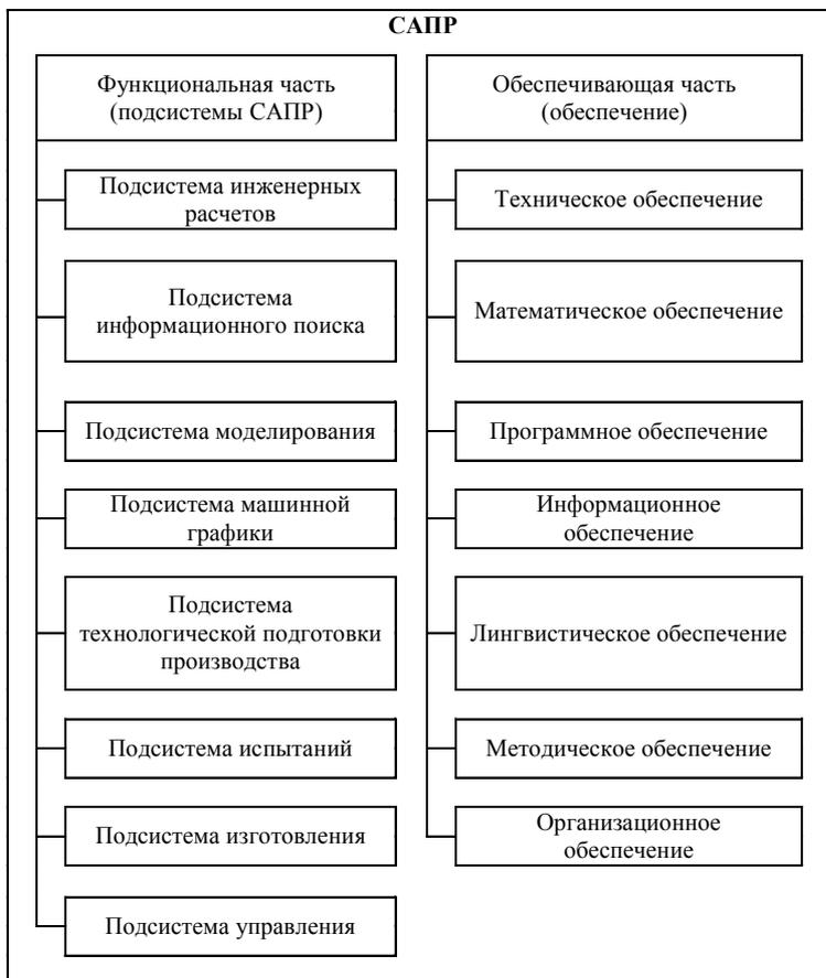
Рис. 2.2. Структурная схема САПР
