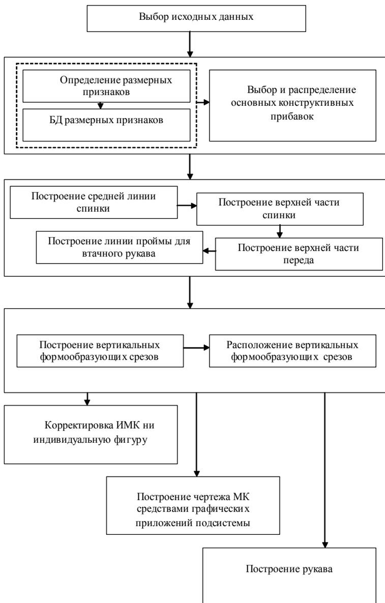
Рис. 4.2. Логическая структура процесса проектирования женской плечевой одежды в автоматизированном режиме
