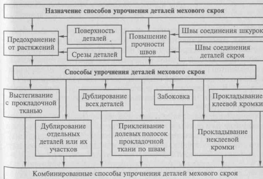
Рис. 4.1. Классификация способов упрочнения деталей мехового скроя
