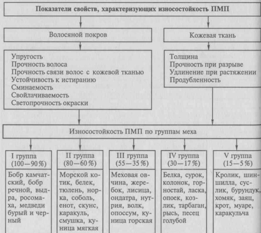
Рис. 1.17. Классификация ПМП по износостойкости
